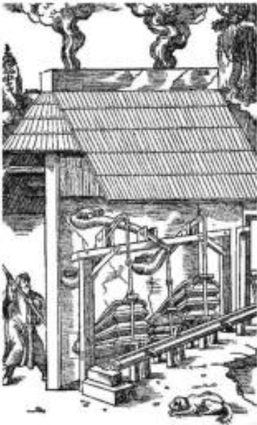
Beispiel eines mit Wasserkraft betriebenen Gebläses für einen Hochofen. Am rechten Bildrand ist noch das Wasserrad zu erkennen.
